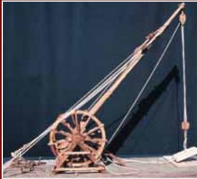
te il trasporto (fig.1), e da propulsore, durante il sollevamento. I cilindri erano sufficientemente grandi da poter ospitare un certo numero di persone che, camminandovi all'interno, imprimevano la rotazione al perno principale. Qui era fissata la fune di sollevamento, sostituita all'occorrenza da quella necessaria
